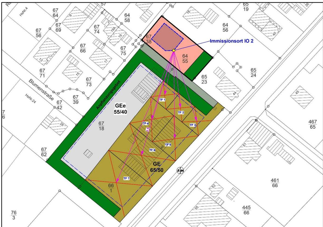
Die Ermittlung des Beurteilungspegels am Immissionsort erfolgt zunächst gesondert für jede einzelne Teilschallquelle nach der Formel  $L_{r,i} = L_W - \Delta L_{s,i} - \Delta L_{BM,i}$ .
